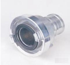
Die schnelle und problemlose **Schlauchkupplung** — zum sicheren Verbinden von Schläuchen zum Saugen und Drücken von Flüssigkeiten, Pulver und Granulaten. Für praktisch alle vorkommenden Schlauch-größen in den Nennweiten 25 bis 250 mm. Je nach Ausführungsformen für Drücke von 600 bis 4000 kPa und je nach Dichtungs-material
